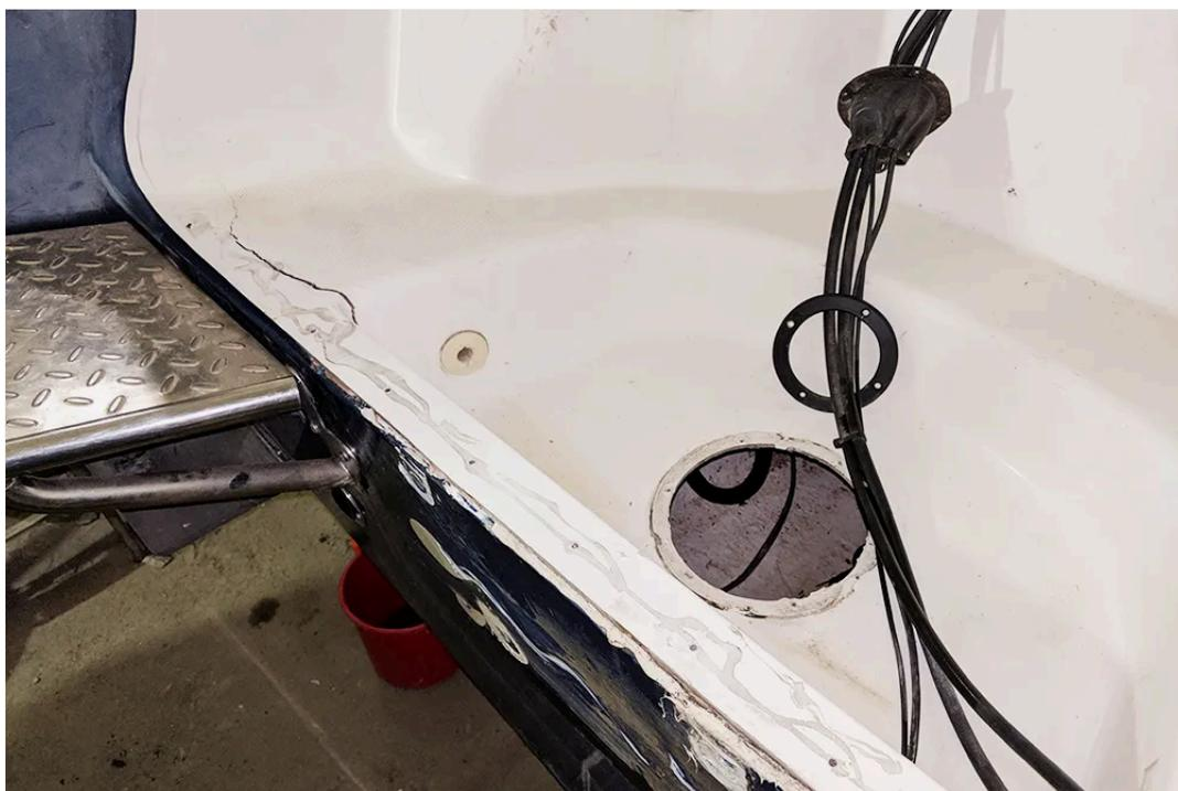
1/3 Появившаяся трещина в кормовой части корпуса. Фото со снятым двигателем
